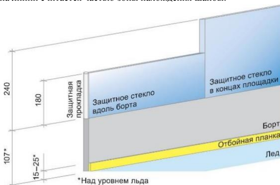
Рисунок 3: Размеры защитного стекла. Эта диаграмма использована с разрешения ИИФ. (Все измерения в см).
