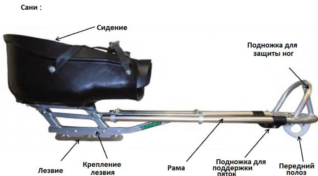
Рисунок 12. Сани и их строение. Рисунок использован с разрешения Unique Inventions Inc.
