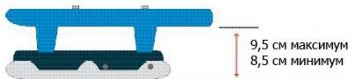
Рисунок 17: Минимальная и максимальная высота рамы.
