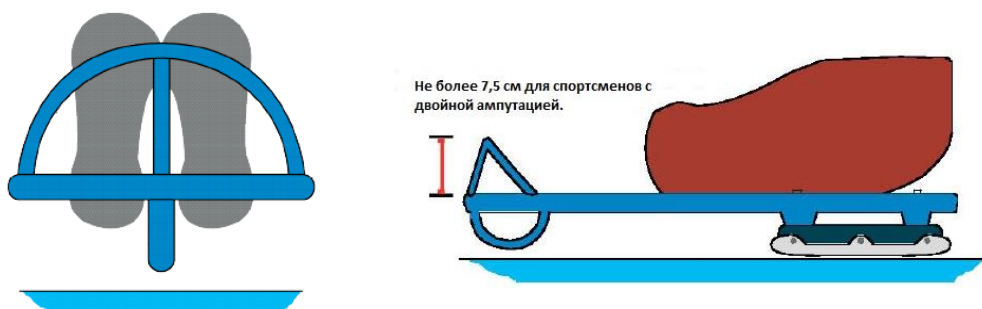
Рисунок 21: Подножка для защиты ног должна быть достаточно высокой, чтобы защитить ноги игрока. Для игроков с двойной ампутацией нижних конечностей высота подножки для защиты ног должна быть не ниже 7,5 см.
