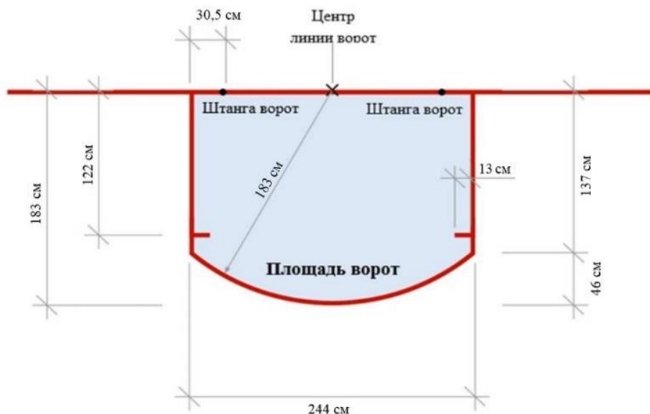
Рисунок 9: Размеры площади ворот. Эта диаграмма использована с разрешения ИИHF.
